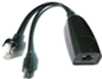
Le système POE permet de délivrer la puissance électrique à la caméra sans avoir besoin de la brancher sur le secteur.
